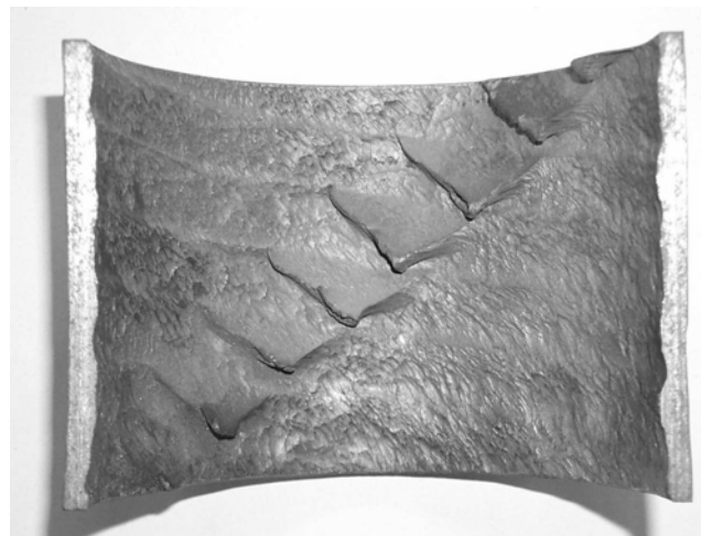
Bild 15: Schuppenbildung an der Innenoberfläche einer Rohrluppe
