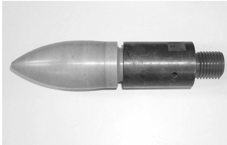
Bild 11: Keramikdorn mit Adapter zum Schrägwalzlochen von Kupfer
