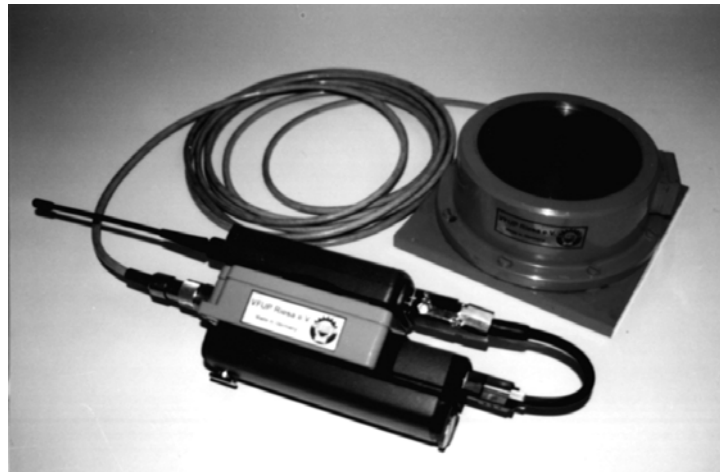
Bild 17: Mobile Messtechnikkomponenten für den universellen Einsatz mit angeschlossener 2000 kN Kraftmessdose
