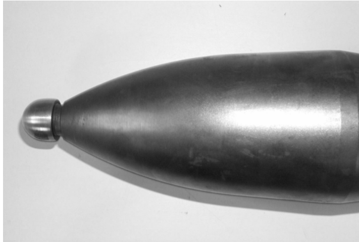
Bild 7: Dorn zur Messung der Dornspitzenkraft
